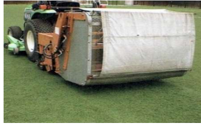
パイル片の除去
